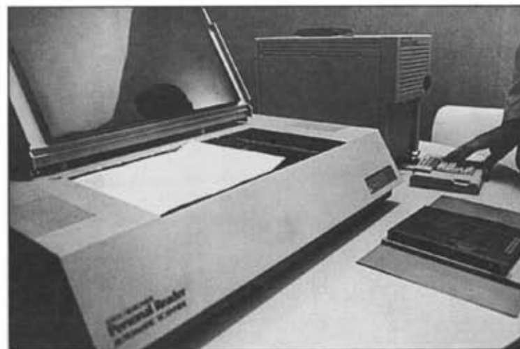
El equipo lector se compone de un escáner, donde se colocan las páginas impresas, y de un sencillo teclado
